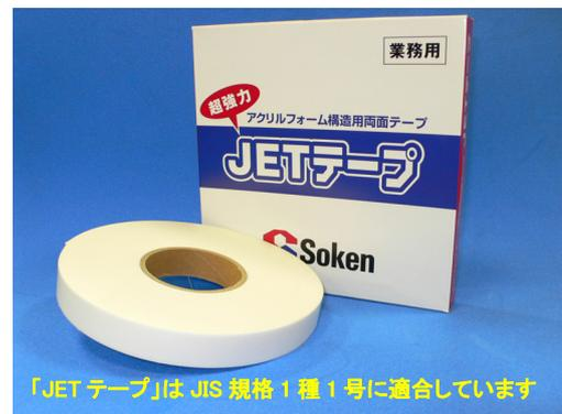
綜研化学の「JET(ジェット)テープ」はアクリルフォームを使用した構造用の両面テープです。接合力の強さに加え、テープに柔軟性、伸縮性があるため曲面での接着にも力を発揮します。金属とプラスチックというような異なる素材同士も貼り付きます。現在、金属性の天井パネルの固定や屋外看板の取り付け、住宅ではドアの貼り合せやキッチン・バス周りの化粧板固定、エレベーターや自動車の内装材固定に使用されるほか、防水シール性に優れているので薄型タイプは電子産業でも活躍しています。
